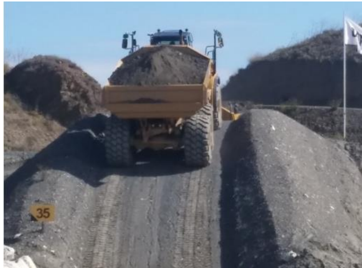
Figura 3.5 – Dúmper extravial articulado subiendo rampa del 35%
