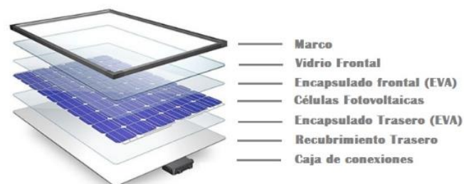
Figura 5.16. Estructura Típica de un Módulo Fotovoltaico. [46]
