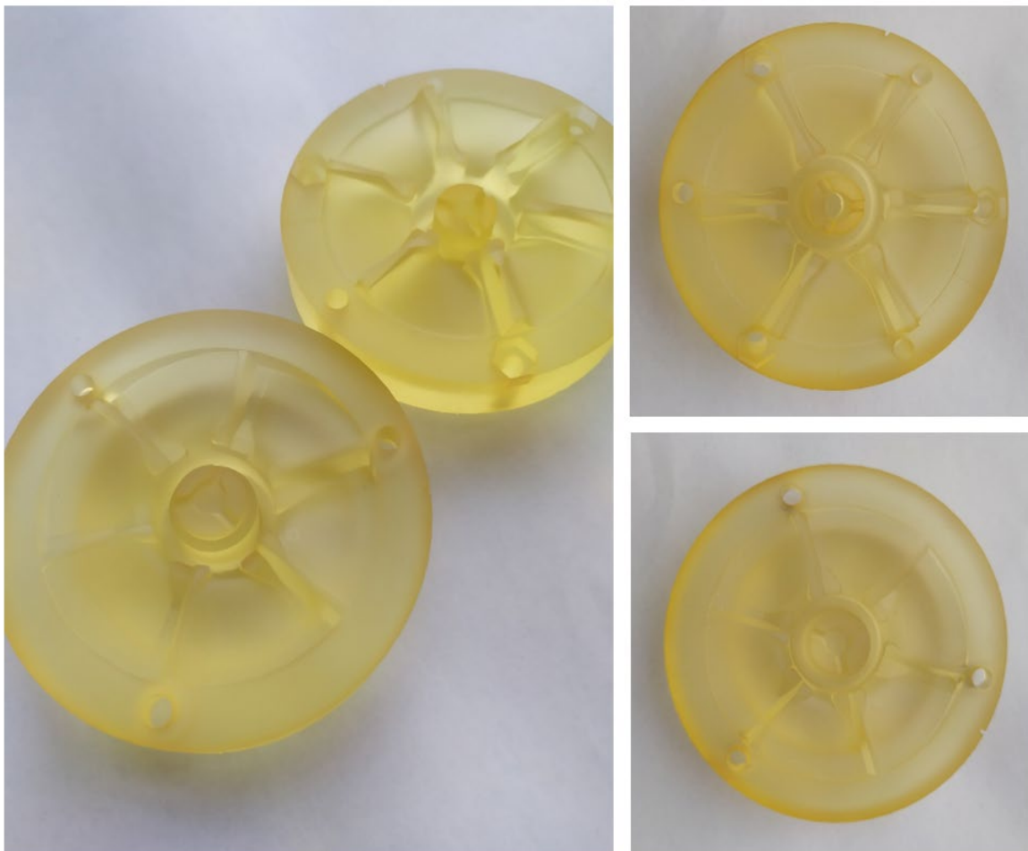
Ilustración 88. Resultado final del molde tras los procesos de curado y tratamiento térmico.
