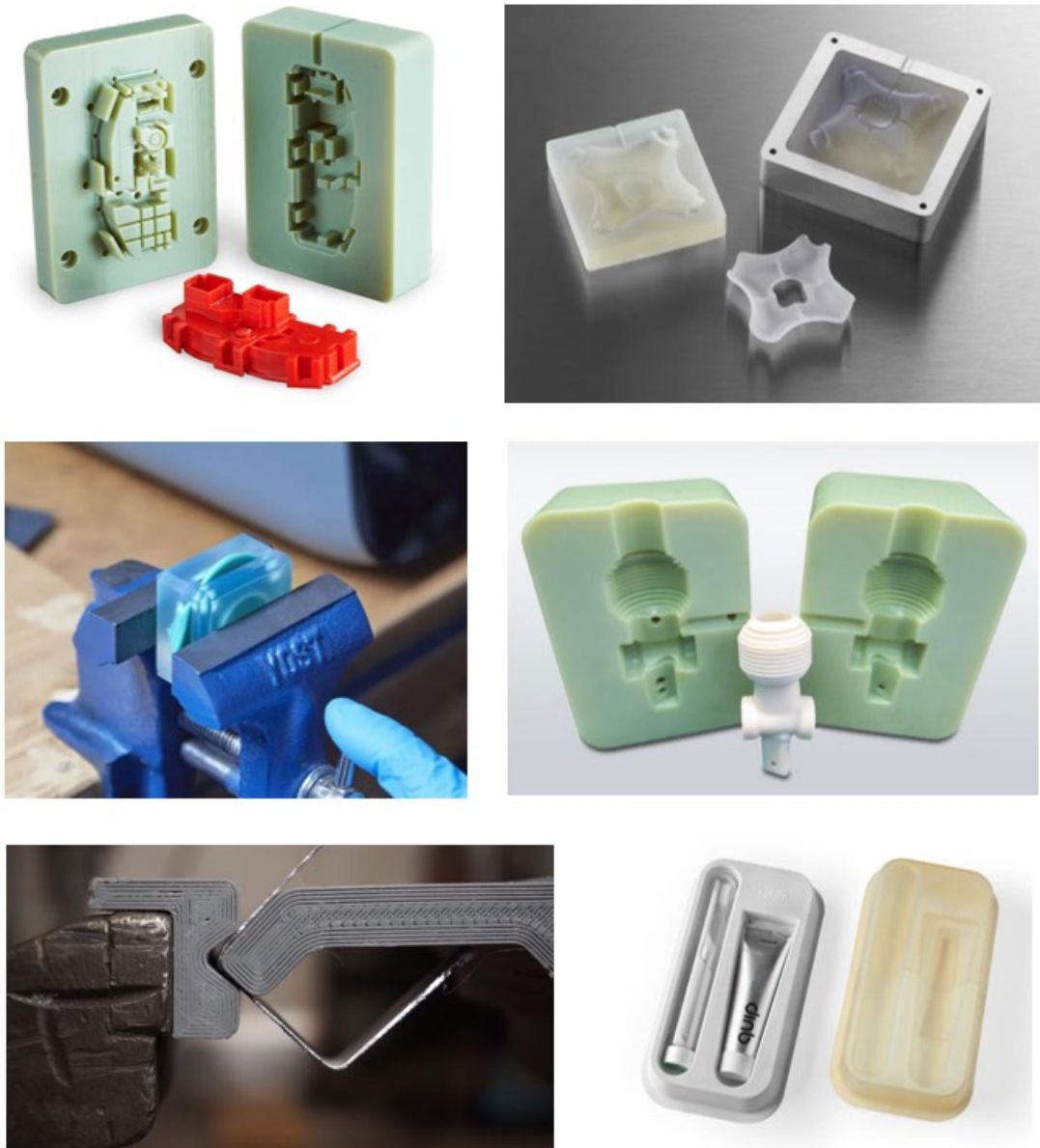
Ilustración 7. Impresiones 3D utilizadas en el proceso de moldeo de inyección ( arriba izquierda , tomada de https://www.3dcadportal.com/notas-de-prensa/peel-adopta-la-impresion-3d-para-desarrollar-molde-de-inyeccion y arriba derecha , tomada de https://formlabs.com/es/blog/impresion-3d-para-moldeo-inyeccion/ ), moldeo por compresión ( medio izquierda , tomada de https://formlabs.com/es/blog/moldeo-compresion/ ), moldeo con silicona ( medio derecha , tomada de https://mz3d.net/servicios/fabricacion-por-molde-de-silicona/ ), moldeo en vacío ( abajo derecha , tomada de https://formlabs.com/es/blog/introduccion-moldeo-vacio/ ) y conformado de chapa metálica ( abajo izquierda , tomada de https://3dwork.io/plegadora-con-impresion-3d/ ).
