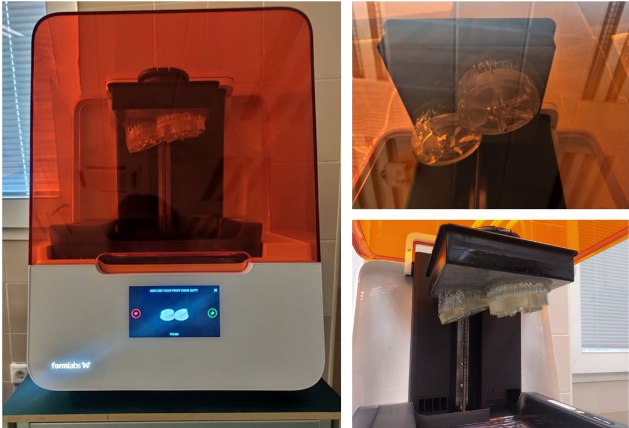
Ilustración 81. Finalización de la impresión 3D del molde.
