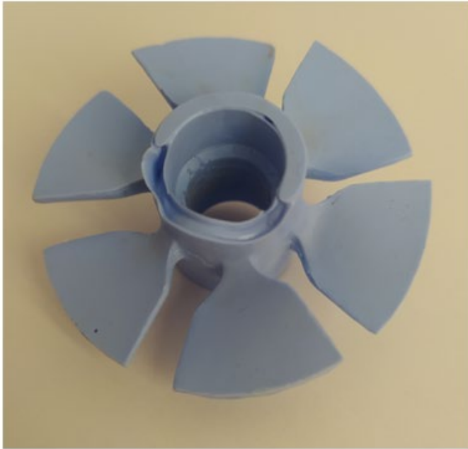
Ilustración 96. Atrapamiento de aire en la parte superior del eje.
