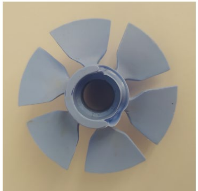
Ilustración 96. Atrapamiento de aire en la parte superior del eje.
