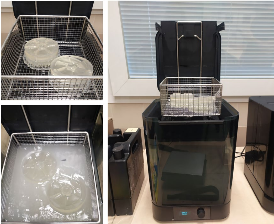
Ilustración 82. Proceso de lavado y secado del molde.
