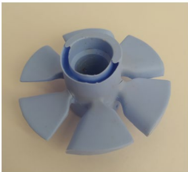
Ilustración 97. Atrapamiento de aire en la parte inferior del eje.
