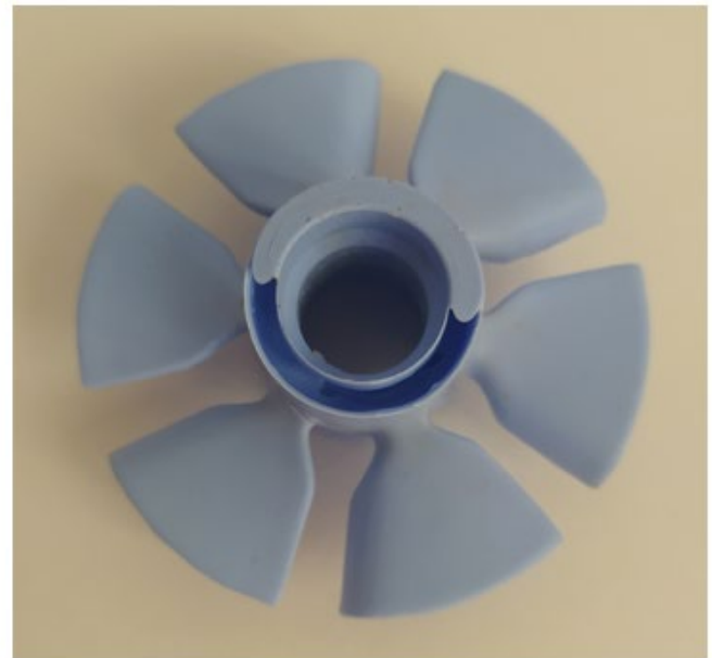
Ilustración 97. Atrapamiento de aire en la parte inferior del eje.
