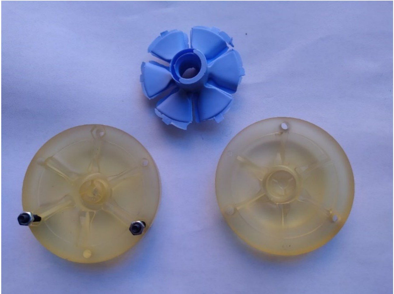
Ilustración 95. Hélice desmoldada completamente.
