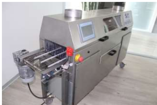
Figura 7. Túnel de irradiación UV para alimentos. Se puede controlar la exposición a la luz UV modificando el tiempo de velocidad de la cinta transportadora. Fuente: GTG Ingenieros. [Imagen]. TUViC-Túnel de Tratamiento UV-C. Recuperada de: https://gtg.es/tuvic-tunel-desinfeccion-uv/
