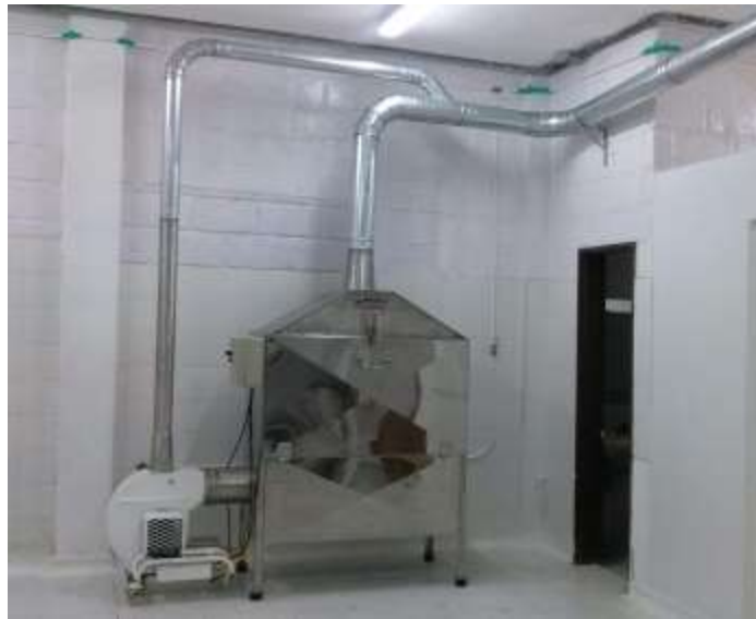
Figura 2. Secador de alimentos por aire caliente forzado. El alimento húmedo es sometido a una corriente de aire caliente a través del conducto de secado. Fuente: Vibrasec SA. [Figura]. Recuperada de: https://vibrasec.com/productos/secado-por-corriente-de-aire/
