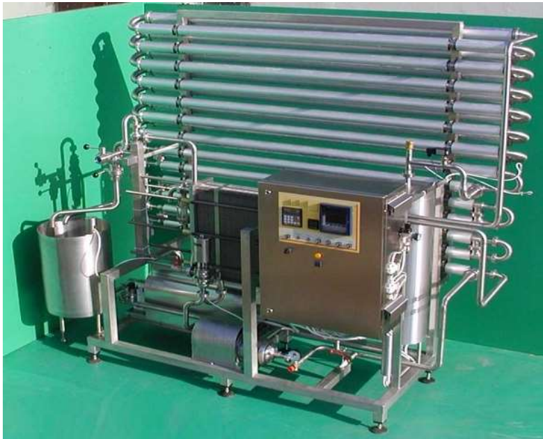
Figura 6. Intercambiador de calor por placas. Recordar que los equipos de pasteurización y esterilización, no son más que intercambiadores de calor donde se controlan los tiempos y temperaturas. Intercambiadores de calor hay de números tipos, destacando los de placas (el de la figura) y los multitubulares. Fuente: Risto. [Imagen]. Pasteurizador de leche pasteurizadores de leche Risto. Recuperada de: http://www.tanque-de-leche.com/milch-pasteurisateur-pasteur-pasteurisateuren.php#
