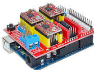
Figura 33. Conexión de Arduino UNO con GRBL y DRV8825.
