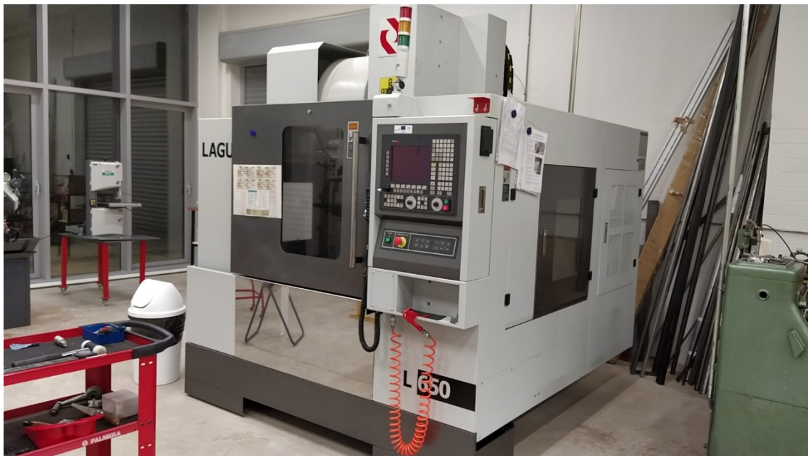
Figura 17. Centro de mecanizado de 3 ejes LAGUN L650.
