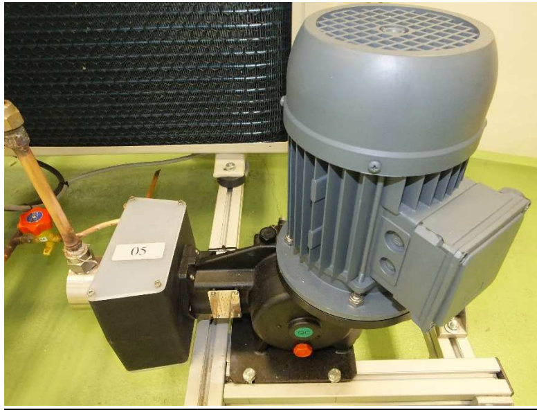
Ilustración 5: Bomba de refrigerante
