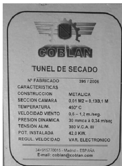
Ilustración 3: Especificaciones técnicas del túnel de secado
