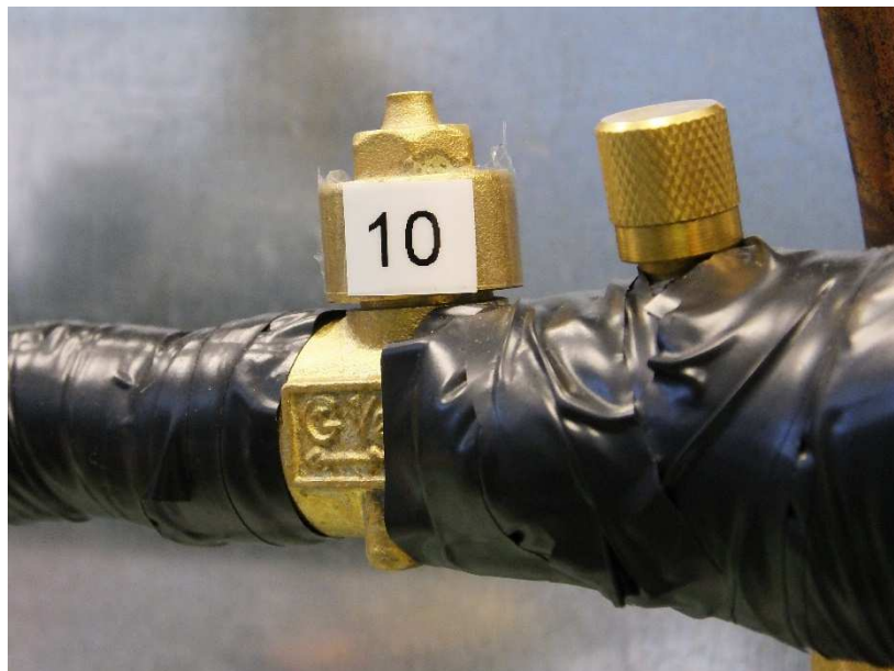
Ilustración 10: Válvula de bola con obús
