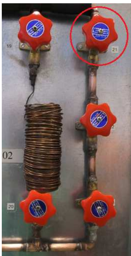
Ilustración 60: Válvula de volante 21 y tubo capilar
