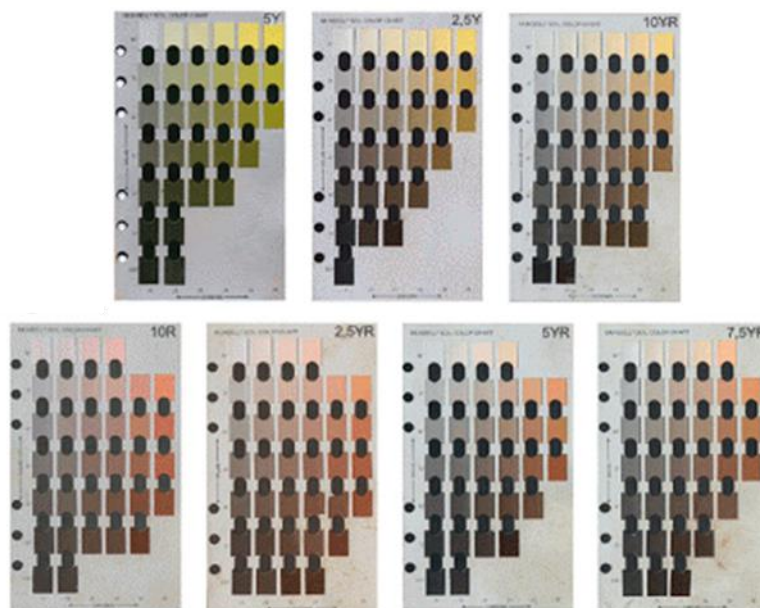
Figura 1. Tablas Munsell para identificar el color del suelo. Elaboración propia.
