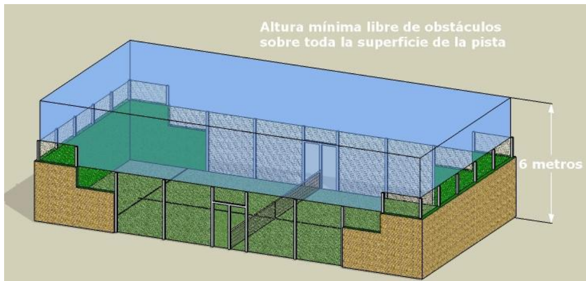
Ilustración 27. Fuente: Federación internacional pádel. Altura mínima libre II
