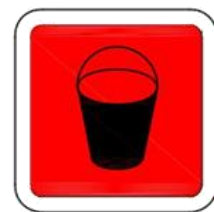
CUBO PARA USO EN CASO DE INCENDIO
