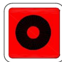
PULSADOR DE ALARMA
