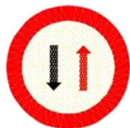
TR-5 PRIORIDAD AL SENTIDO CONTRARIO
