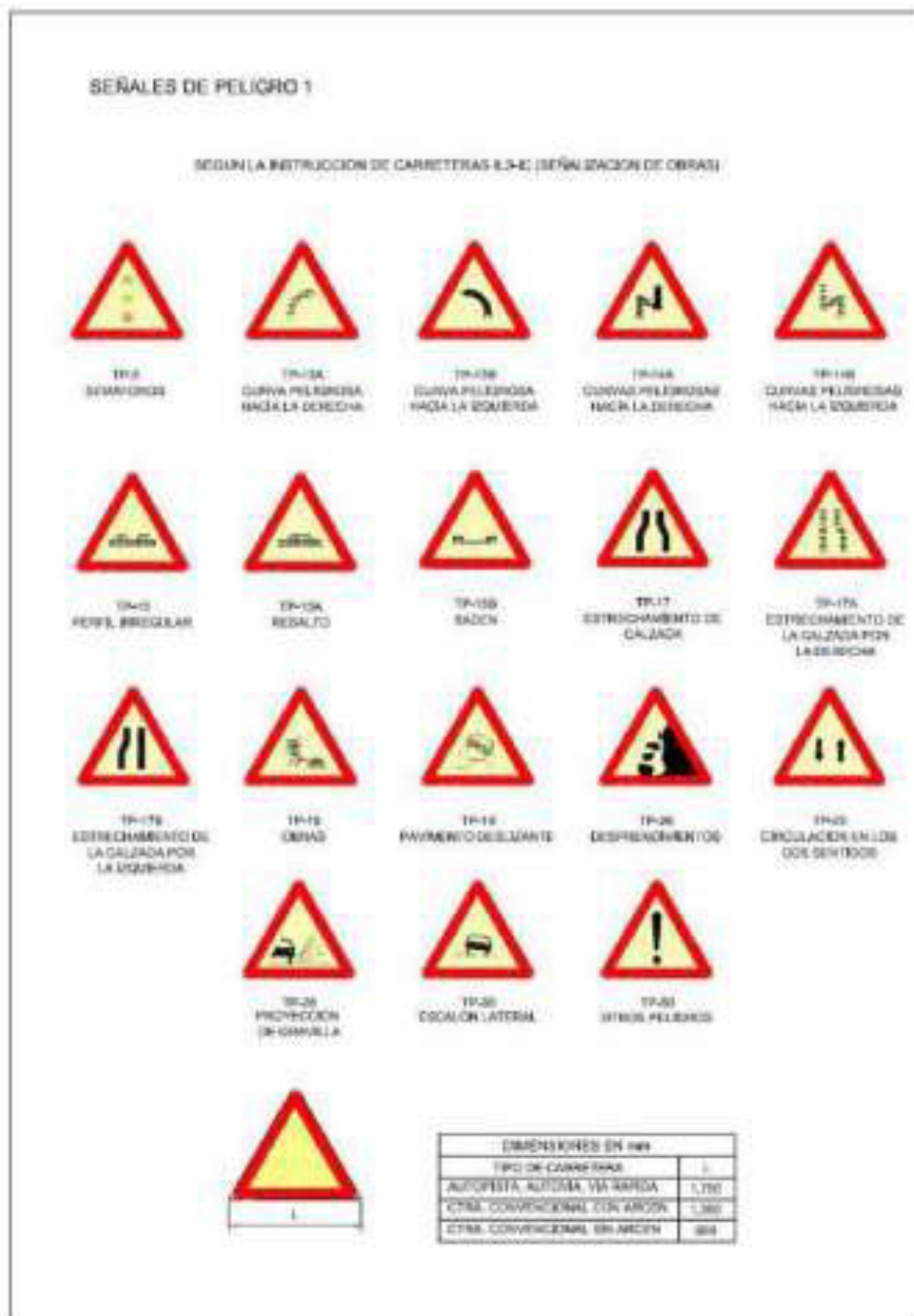
Figura 99: Señales de peligro 1
