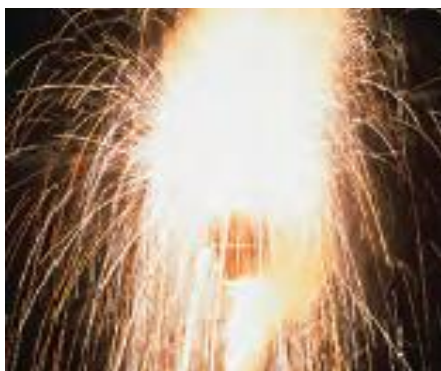
Figura 8. Reacción de la termita. Los átomos de hierro del óxido de hierro (III) ceden átomos de O a los átomos de Al formándose \text{Al}_2\text{O}_3 (Petrucci et al., 2017).
