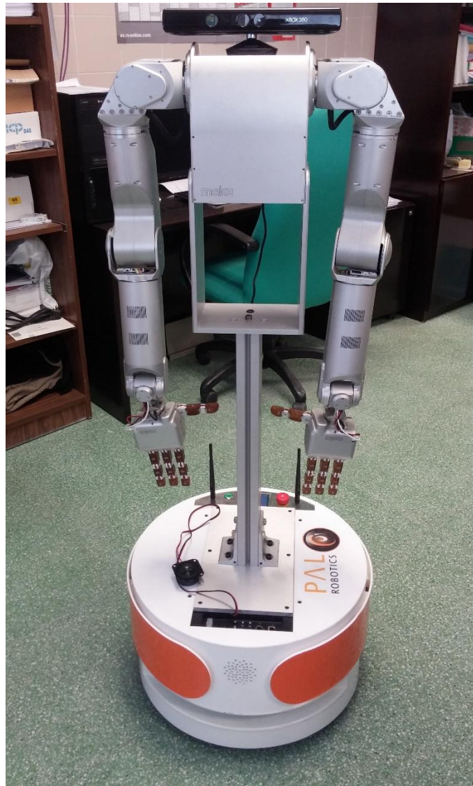
Figura 36: robot Meka colocado sobre el PMB2
