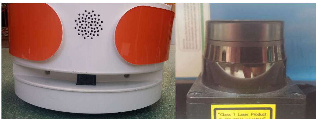
Figura 10: situación del LIDAR (izquierda) y fotografía sin máscara (derecha)
