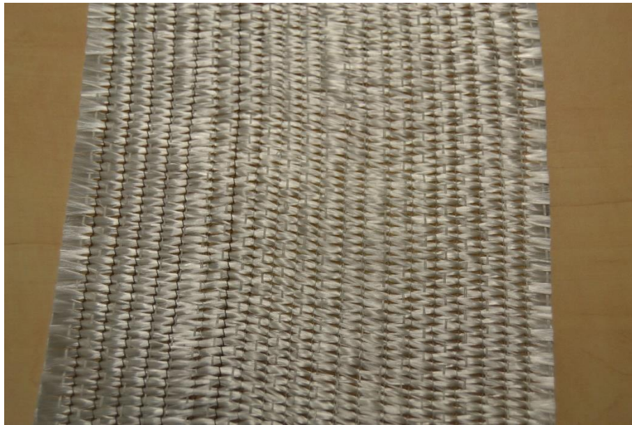
Figura 76. Vista de lámina a 90° cosida.
