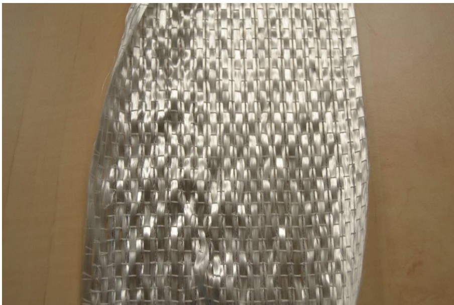
Figura 75. Vista de laminado a 0^\circ cosido.
