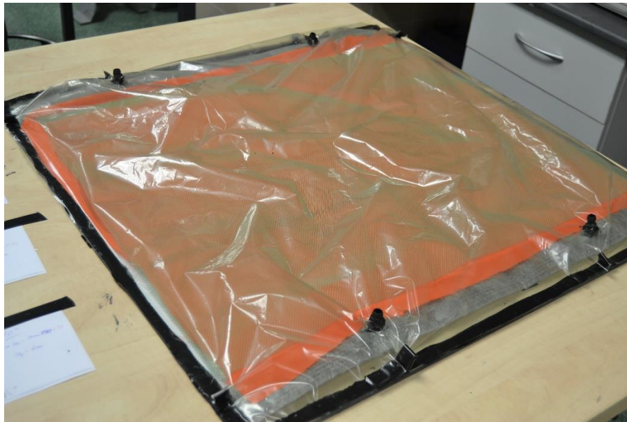
Figura 85. Colocación de la bolsa de vacío.
