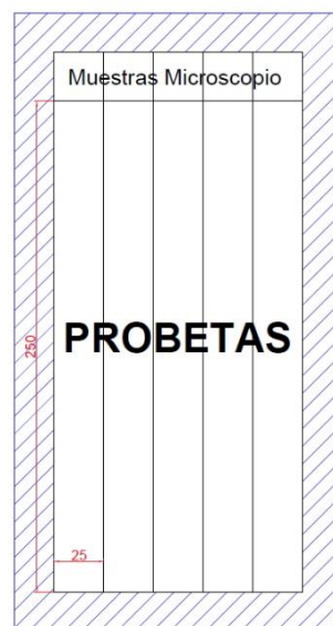
Figura 78. Esquema de disposición de las probetas en los laminados.
