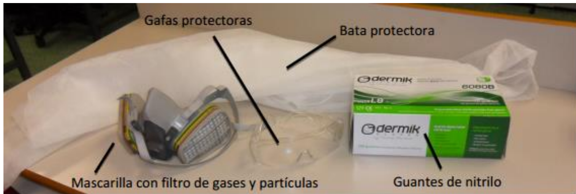
Figura 70. Equipos de protección [7].
