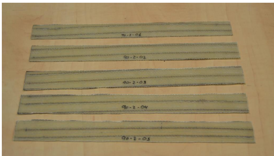
Figura 92. Lámina a 90° cortada.
