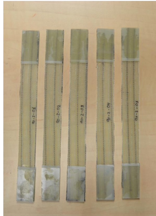
Figura 94. Lámina a 90° con tacones
