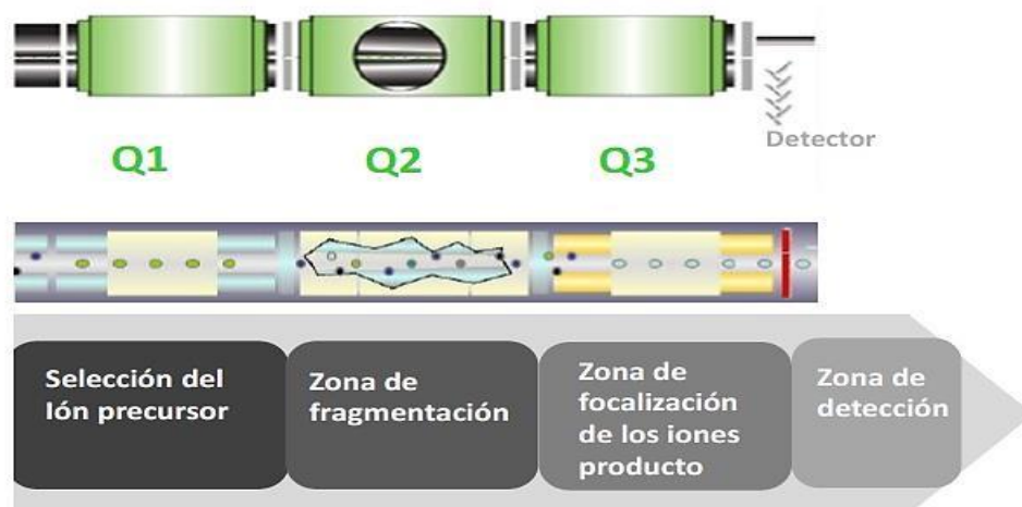
Figura 8. Esquema del proceso de analizador triple cuadrupolo. [Moreno González 2013].
