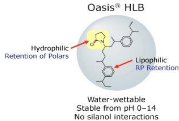
Figura 9. Estructura del sorbente polimérico HLB. [WATERS].
