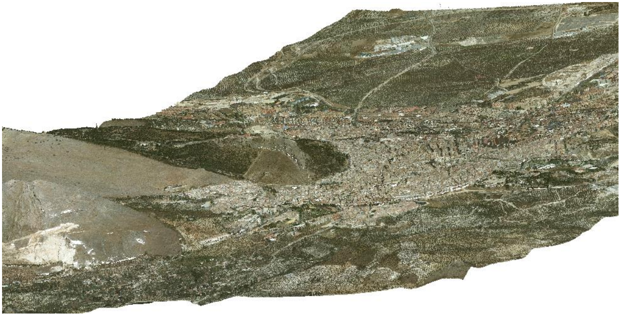
Figura 2.2: Nube de puntos de la ciudad de Jaén generada mediante LiDAR (ALS)
