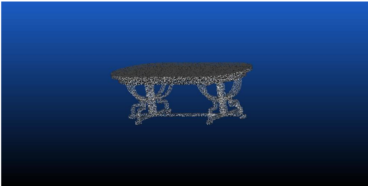
Figura 1.30: Nube de puntos generada mediante muestreo CAD para una mesa
