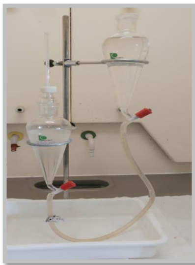
Figura 7. Montaje realizado en el laboratorio para la microextracción líquido-líquido
