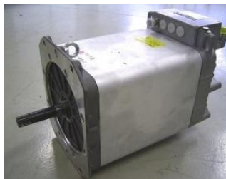
Ilustración 58. Motor asíncrono trifásico para tracción de Siemens modelo 1PV5135WS28.
