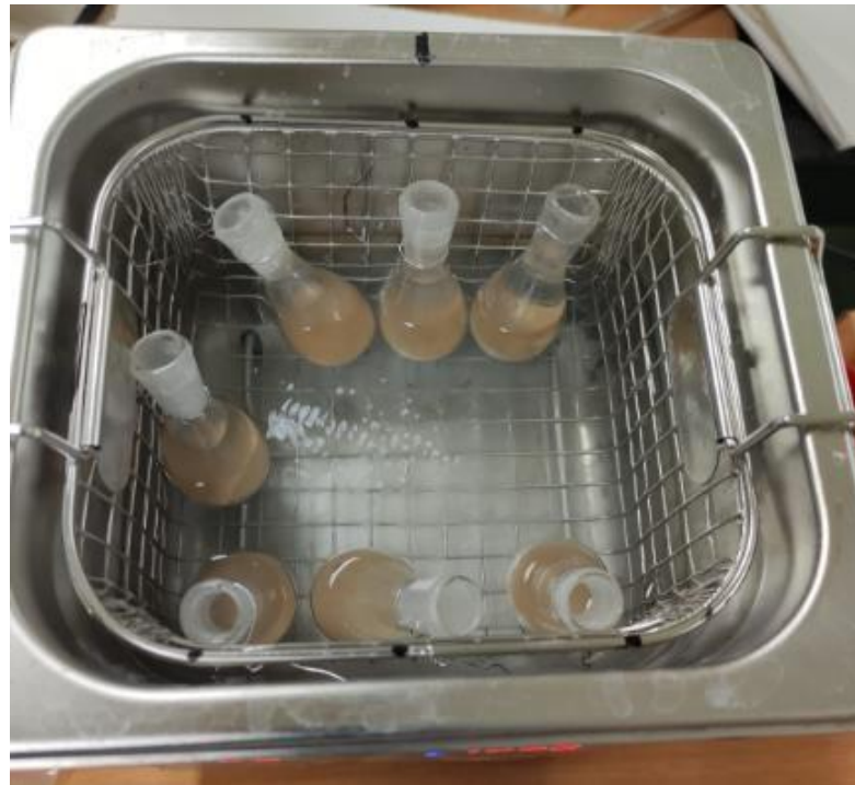
Figura 24. Picnómetros en el equipo de vibraciones de ultrasonidos
