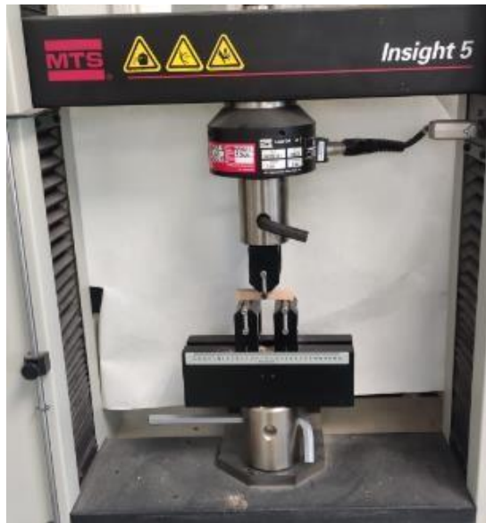
Figura 13. MTS Insight 5. Muestra al inicio del ensayo
