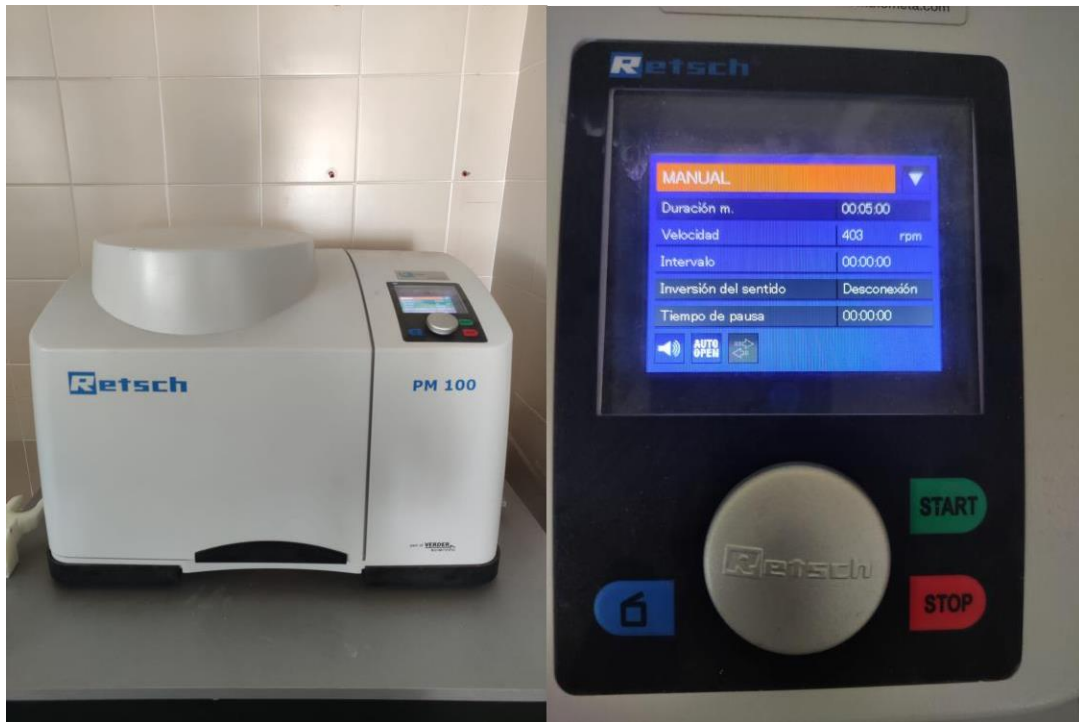
Figura 20. Equipo de molido Retsch PM100
