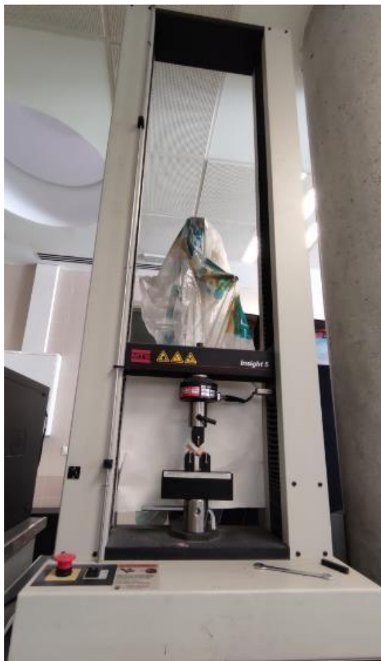
Figura 14. MTS Insight 5. Muestra fracturada
