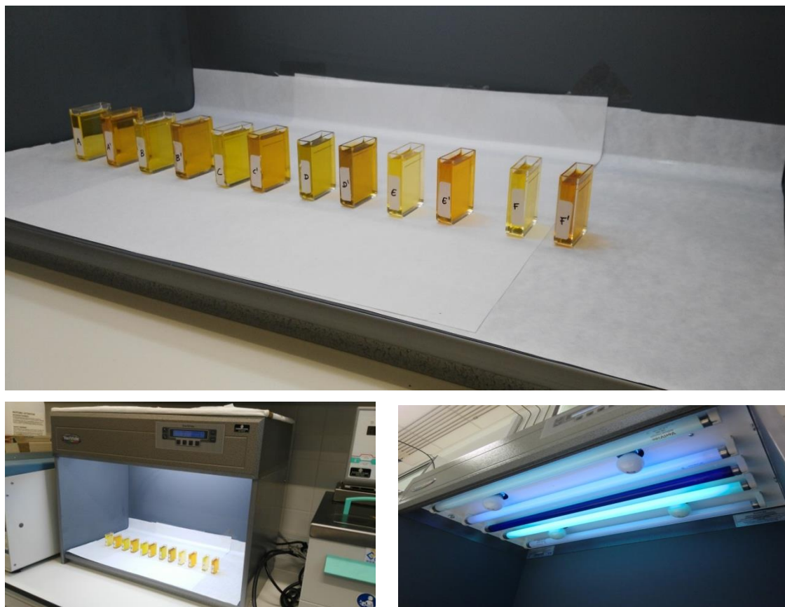
Imagen 15: Muestras de aceites en cabina de control de iluminación (arriba); detalle de la cabina de iluminación ultravioleta (abajo izquierda) y detalle de las diferentes lámparas iluminantes (derecha).
