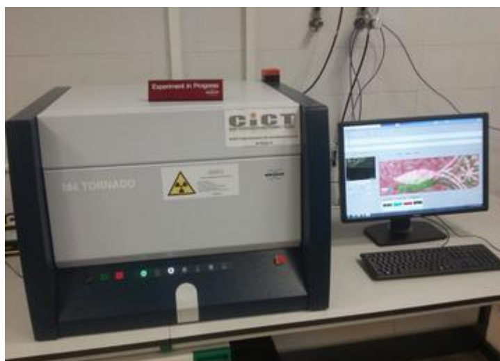
Figura 6: Espectrómetro de micro fluorescencia de rayos X.
