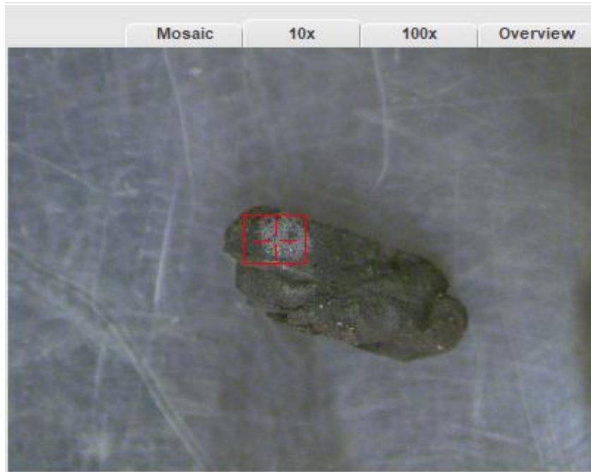
Figura 37: Microfluorescencia de Rayos X, tubo 500 °C, aumento x10, punto 2.
