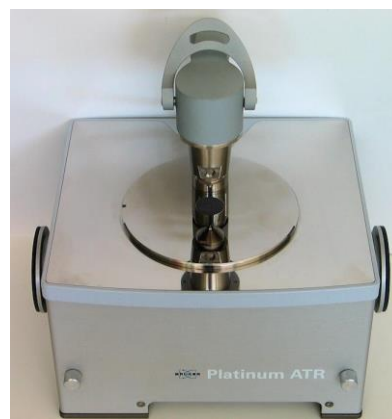
Figura 8: Accesorio ATR con cristal de diamante.
