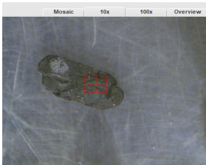
Figura 35: Microfluorescencia de Rayos X, tubo 500 °C, aumento x10, punto 1.
