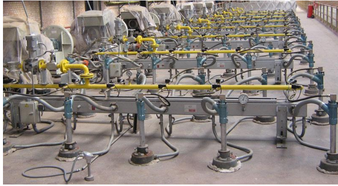
Ilustración 30. Grupo de quemadores de gas dispuestos en el techo. Fuente: EQUIPCERAMIC. https://equipceramic.com/
