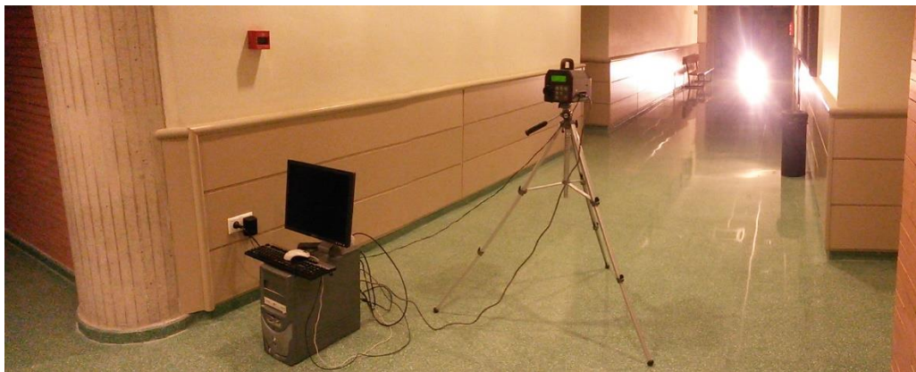
Figura 2.32 Ejemplo de set-up característico de medición parámetros lumínicos. Sin luz ambiente
