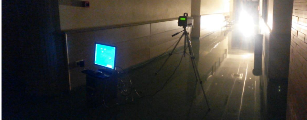
Figura 2.32 Ejemplo de set-up característico de medición parámetros lumínicos. Sin luz ambiente
