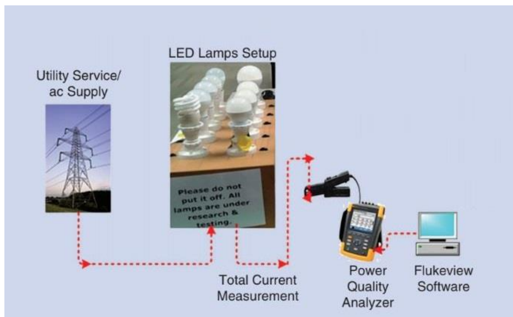
Figura 2.1 Set-up experimental para la medición de parámetros eléctricos. Fuente: Referencia [14]
