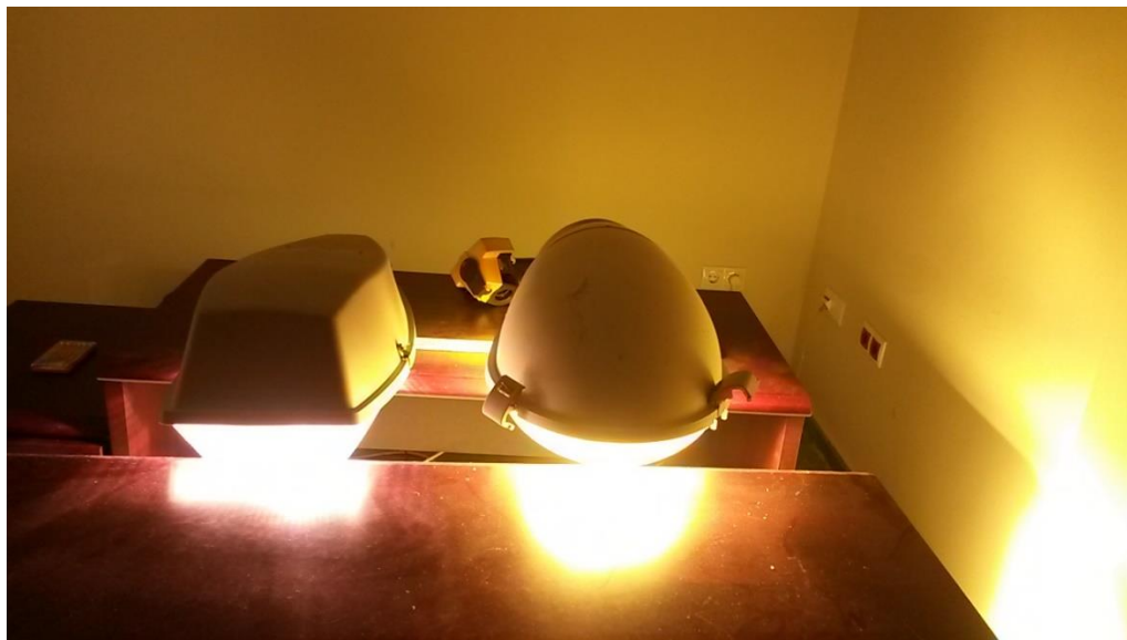
Figura 2.34 Ejemplo de set-up característico para la medición de la disipación térmica
