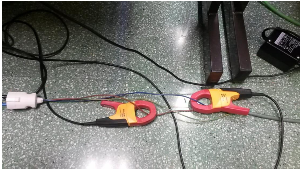
Figura 2.31 Conexión pinzas amperimétricas en fase y neutro de la luminaria bajo ensayo
