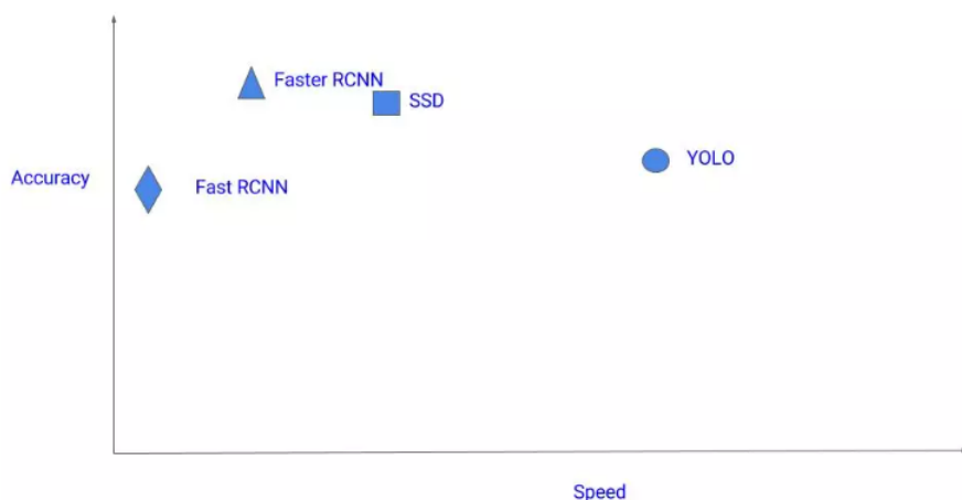
Figura 3.8: Comparación algoritmos precisión/velocidad. (Origen: cv-tricks.com)
