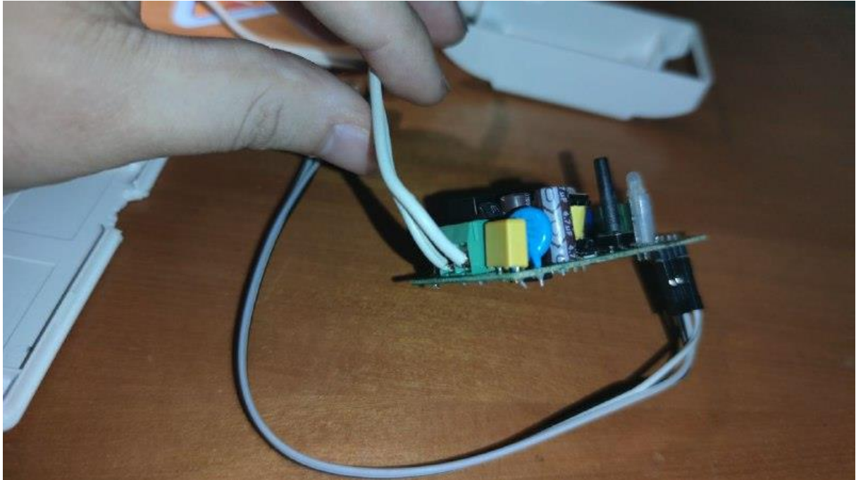
Figura 66.- Sonoff con el cable de alimentación. Fuente: Elaboración propia.
