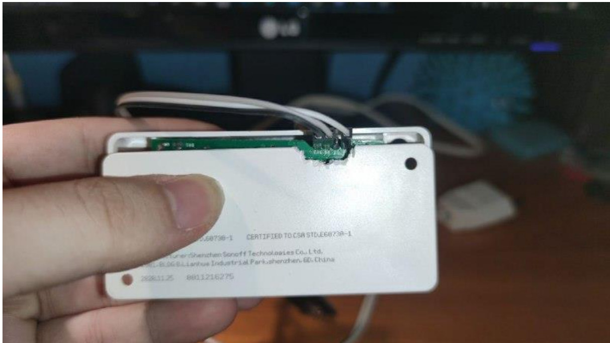
Figura 68.- Modificación de la carcasa del Sonoff. Fuente: Elaboración propia.
