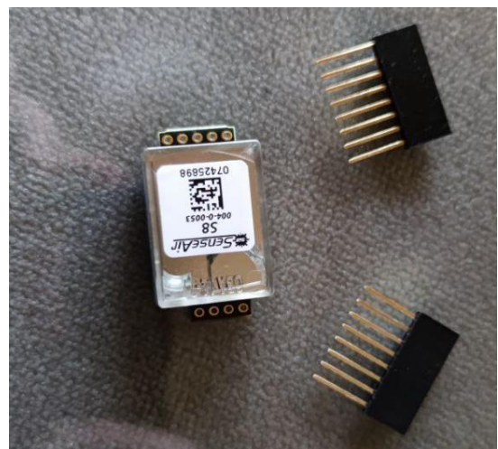
Figura 59.- Senseair S8 (CO 2 ). Fuente: Elaboración propia.
