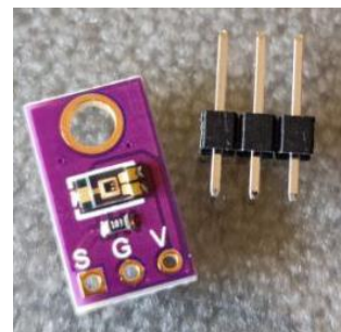
Figura 60.- TEMT6000 (Luminosidad). Fuente: Elaboración propia.
