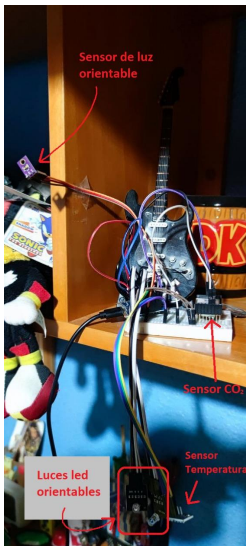
Figura 75.- Disposición 2 de Wemos D1 Mini. Orientado a libertad de posicionamiento de los sensores. Fuente: Elaboración propia.
