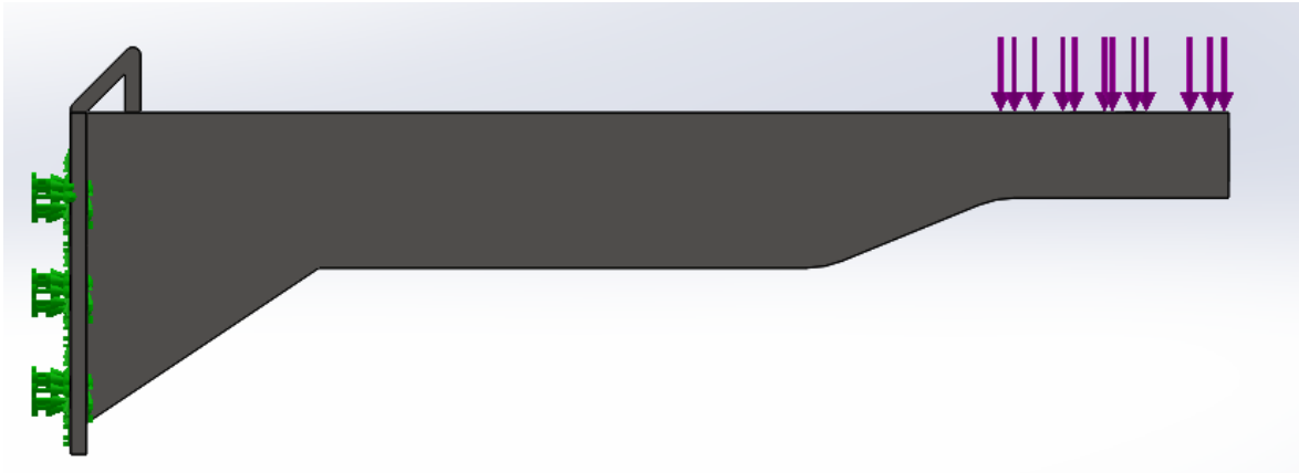
Figura 58 – Brazo twistlock sometido a carga
