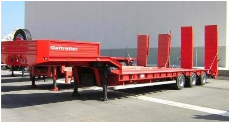
Figura 8 – Semirremolque tipo góndola con perfil doble T [22]
