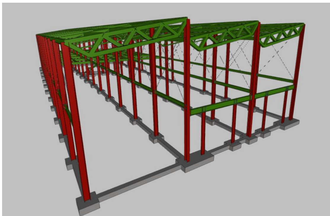
Figura 6. Estructura y cimentación (CYPE 3D)
