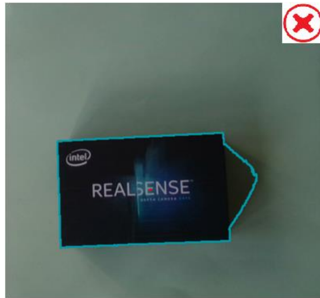
Figura 40: Error en la detección del contorno debido a la falta de iluminación
