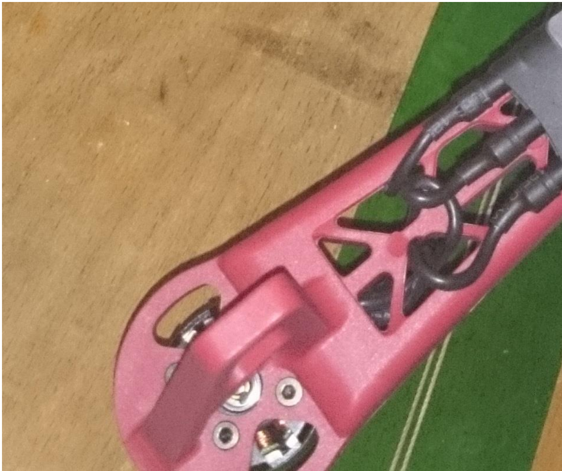
Ilustración 4.23 - Detalle conexión motor y ESC
