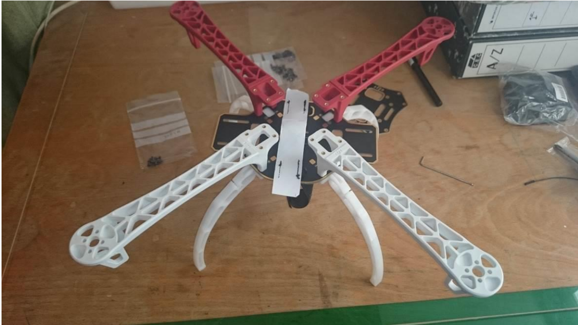
Ilustración 4.20 - Montaje chasis inferior
