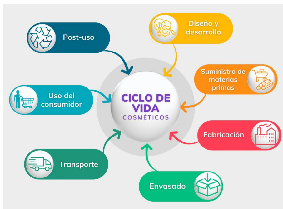
Figura 6. Principales fases del ciclo de vida de un producto cosmético. (Fuente: propia utilizando el programa Canva, basada en la figura 1 del artículo “A sustainable life cycle for cosmetics: From design and development to post-use phase” de Ana M. Martins y Joana M. Marto)
