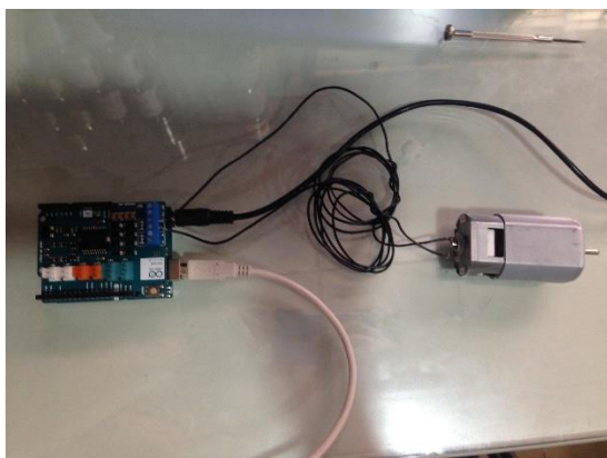
Figura 418: Motor DC brushed controlado con un arduino Uno
