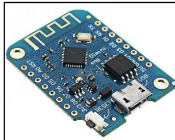
Ilustración 4 – LONIN D1 Mini v3. Fuente: Wemos.
