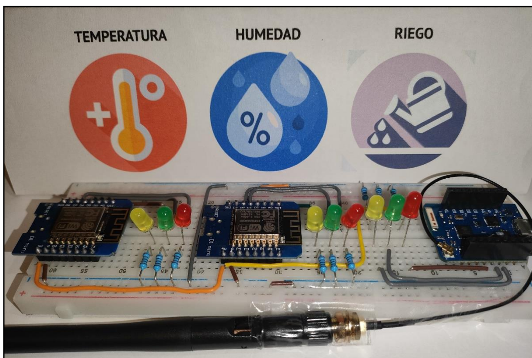
Ilustración 19 – Simulación del sistema de control de temperatura, humedad y riego.
