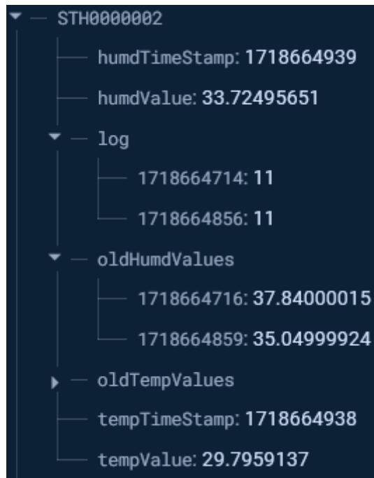
Ilustración 44 – Campos del nodo sensor en Realtime con los registros de error y datos ambientales.
