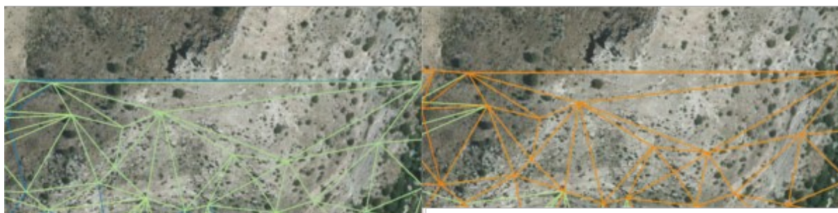
Ilustración 65: Ejemplos sobre el borde de sus triangulaciones. En azul se muestra los segmentos que pertenecen a la triangulación generada por Arcgis Pro. En naranja pertenecen a la triangulación generada por Aplítop Mdt. En verde pertenecen a la triangulación generada por el Plugin de QGIS. Las triangulaciones aparecen superpuestas
