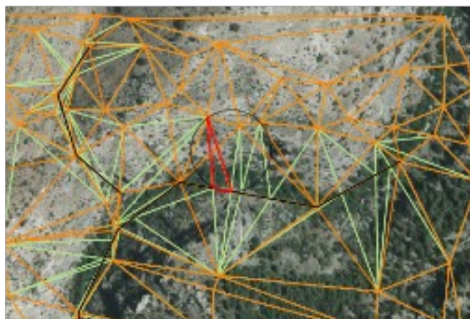
Ilustración 61: Triángulo generado en el proceso de inserción de Líneas de Rotura que no queda validado. Los segmentos negros se corresponden con Líneas de Rotura, la triangulación de color naranja es generada por el software Aplítot MDT. Los segmentos color verde se corresponden a la triangulación generada por el Plugin de QGIS, donde se ha superpuesto la capa debajo de la generada por Aplítot MDT y donde solo se pueden apreciar las diferencias.
