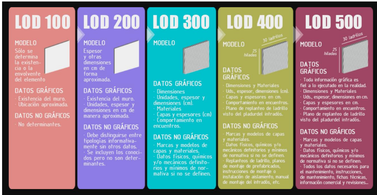
Ilustración 2 LOD de BIM Fuente: https://www.bimnd.es/lo-d-la-metodologia-bim/
