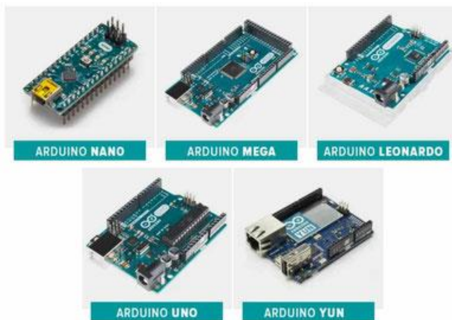
Figura 8. Variantes de Arduino.
