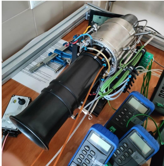
Ilustración 3.1.3 – Imagen del modelo en posesión de la Universidad, donde se ve el tubo de entrada en primer plano.
