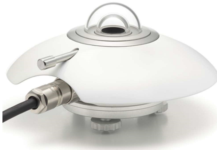
Ilustración 2. Piranómetro, para medir GHI
