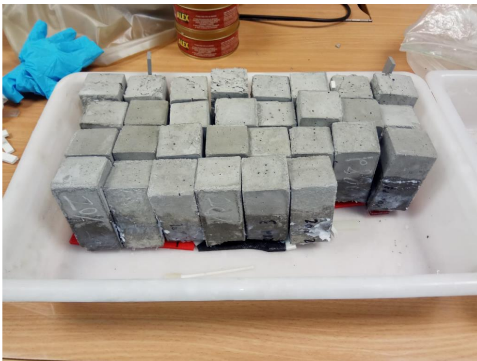
Figura 3.20. Probetas durante el ensayo de absorción de agua por capilaridad.
