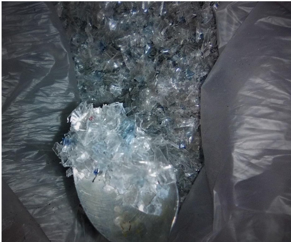
Figura 3.4. PET triturado en forma de escamas.
