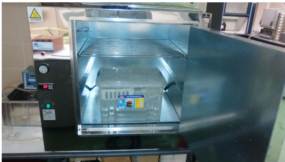
Figura 3.14. Cámara de humedad.
