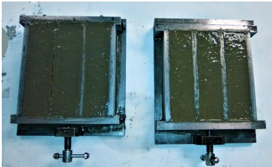
Figura 3.11. Enmoldado de las probetas.
