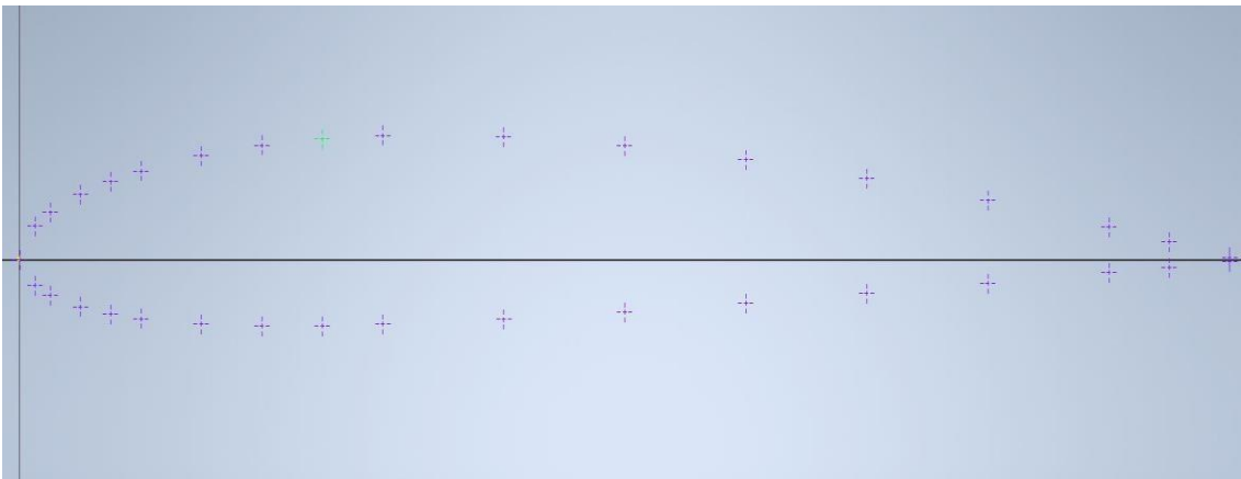
Figura 57: Proyectado de puntos Perfil NACA
