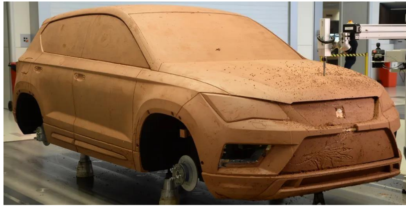
Figura 33: Proceso creación superficies con arcilla de modelaje
