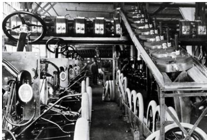
Figura 7: Cadena de montaje Ford model T
