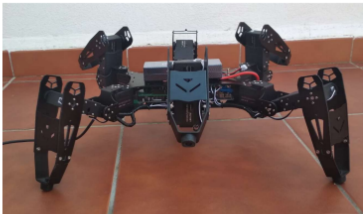
Figura 39: Robot hexápodo mostrando máxima altura de paso
