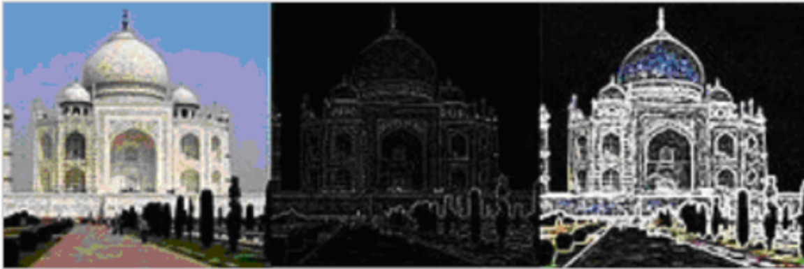
Figura 14: Imagen original (izquierda) frente a imagen tratada con el filtro de Canny (centro) y tratada con el filtro de Sobel (derecha).
