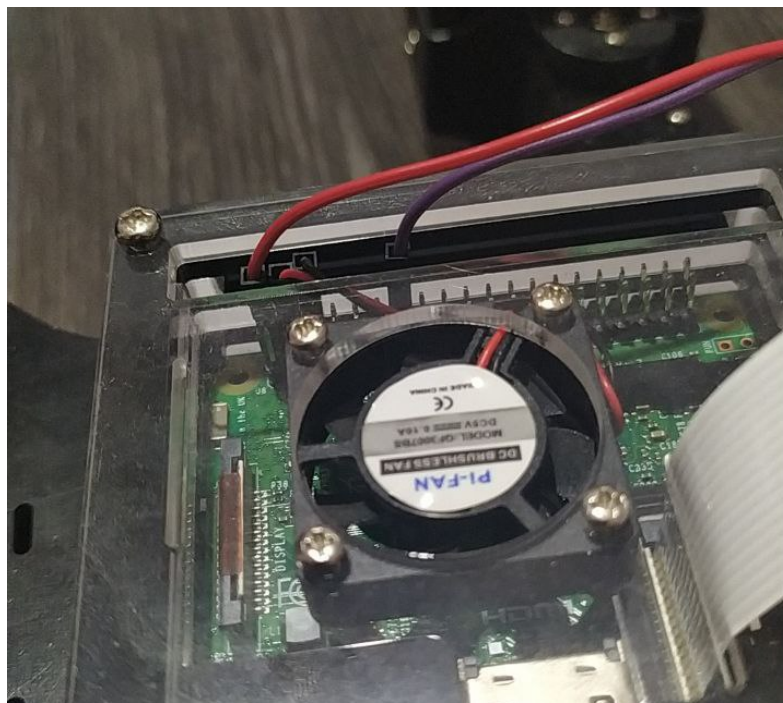
Figura 49: Conexión mediante GPIO del robot a la RaspBerry
