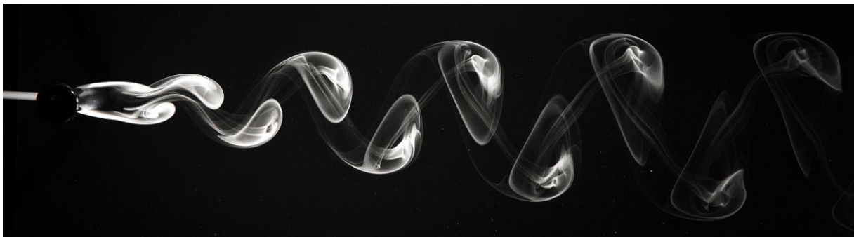
Figura 1. Visualización de vórtices de Von Karma detrás de un cilindro circular en el aire
