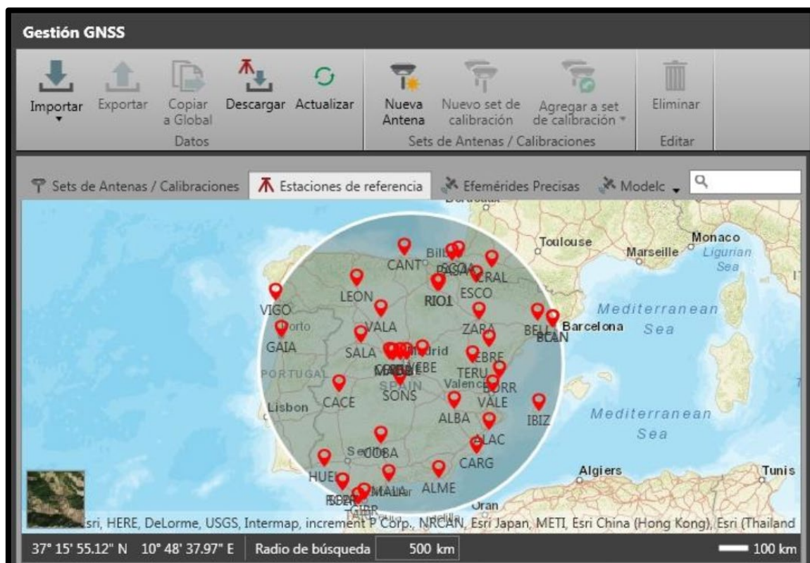
Fig. 20: Herramienta en Leica Infinity para descarga de efemérides precisas.
