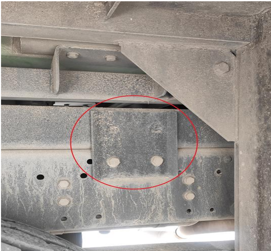
Ilustración 3: Placas de unión entre bastidor y falso-bastidor.
