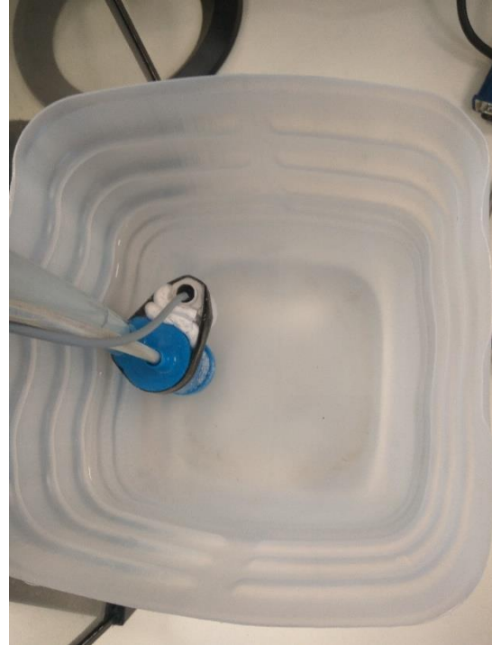
Ilustración 58. Bomba de Agua y Sensor de Nivel
