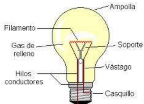
Ilustración 27. Partes de una bombilla
