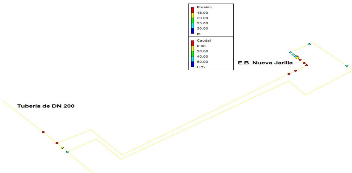
Figura 3.18. E.B. Nueva Jarilla en línea en la tubería de DN 200 de entrada a la urbanización Nueva Jarilla con la que se pretende mejorar las presiones en toda la urbanización y reducir al mismo tiempo las presiones alcanzadas en el barrio de San José de la Rinconada. Fuente: producción propia basada en el uso de EPANET
