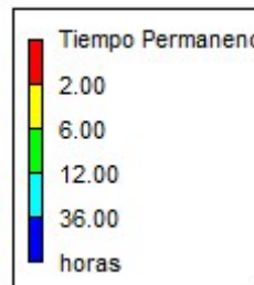
Figura 1.18. Código de colores para los valores del tiempo de permanencia en los nudos. Fuente: producción propia basada en el uso de EPANET
