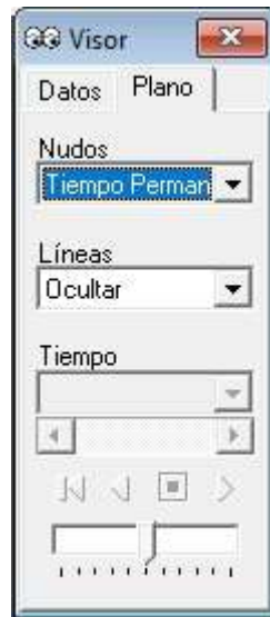
Figura 2.8. Se seleccionará en el visor en los nudos Tiempo Permanencia como el parámetro a ver en el plano. Fuente: producción propia basada en el uso de EPANET
