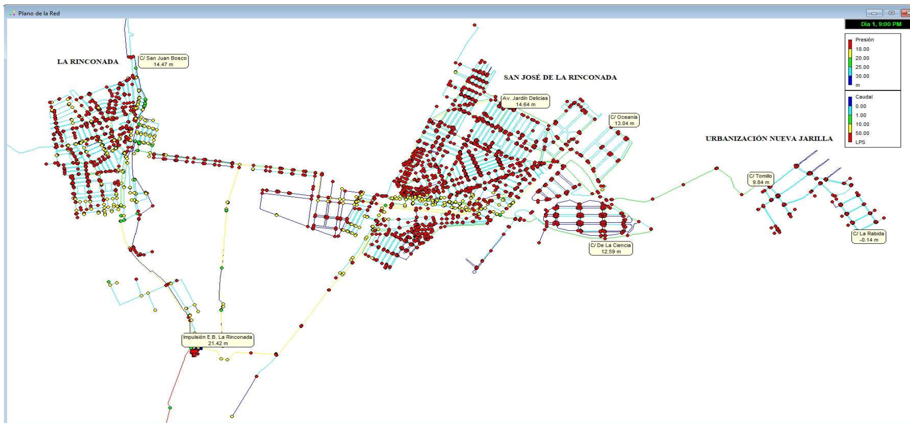
Figura 3.2. Presiones mínimas en la red actual simuladas en un escenario de consumos máximos (envolvente de mínimos) sin bombeo en E.B. La Rinconada. Fuente: producción propia basada en el uso de EPANET
