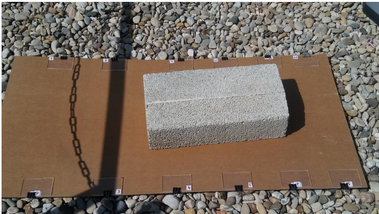
Figura 4.12. Instalación de placas de PMMA para la acumulación de soiling.
