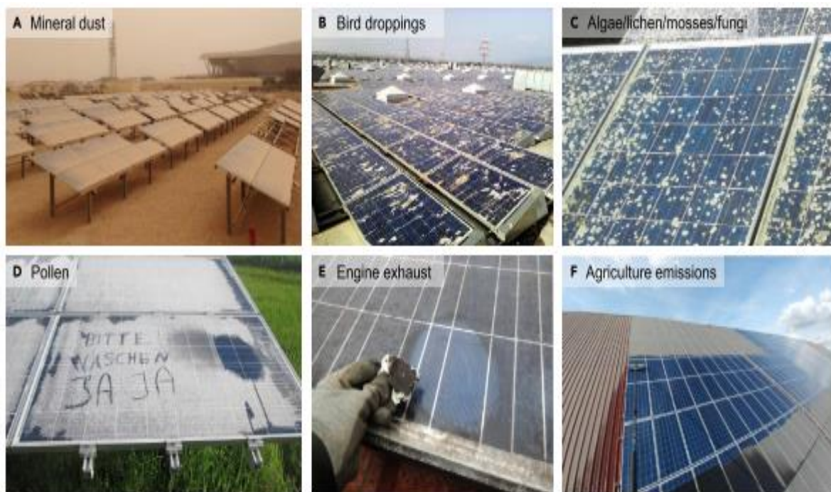
Figura 2.1. Módulos FV con diferentes tipos de soiling [6].
