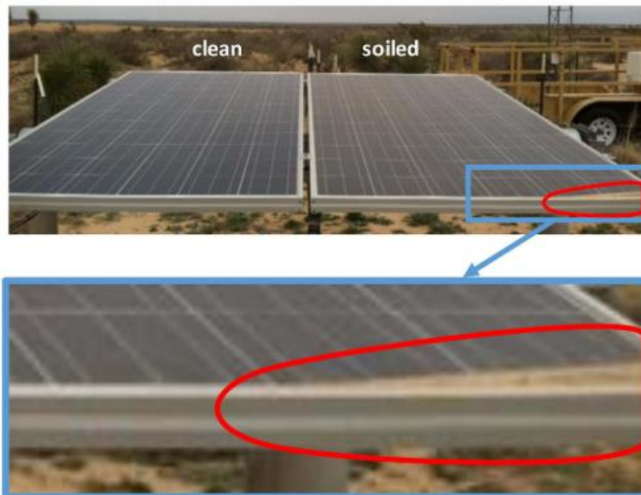
Figura 2.7. Efecto de la no uniformidad del soiling en el cálculo del SRatio [5].
