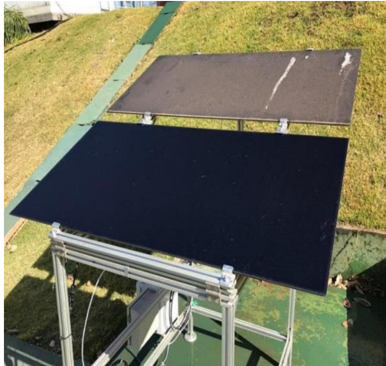
Figura 3.1. Estación de soiling en Belo Horizonte (Brasil) [39].
