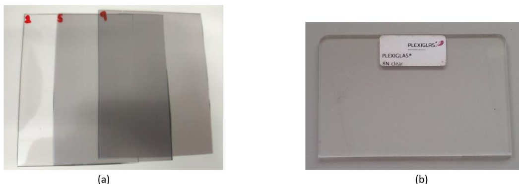
Figura 4.8. (a) Máscaras de calibración. (b) Placas de PMMA.
