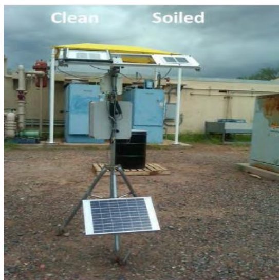
Figura 3.3. Waterless Soiling Station desarrollada por la Universidad Estatal de Arizona [42].
