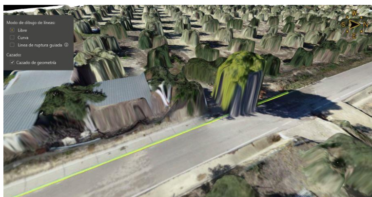
Ilustración 2.43. Composición entre ortofoto y nube densa de puntos
