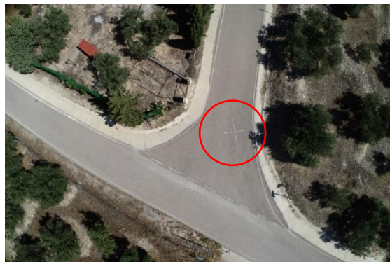
Ilustración 2.22. Marca de punto de apoyo fotografía aérea
