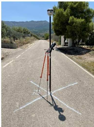
Ilustración 2.25. Equipo GNSS en trípode de pinza sobre marca de punto de apoyo
