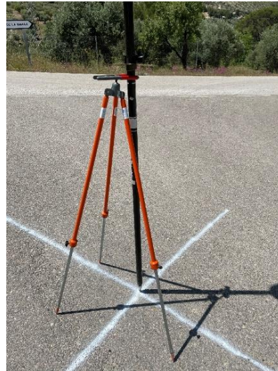
Ilustración 2.26. Equipo GNSS en trípode de pinza y marca de punto de apoyo
