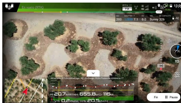
Ilustración 2.30. Telemetría en vuelo y vista desde cámara
