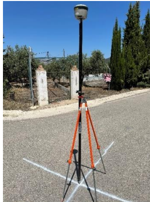
Ilustración 2.21. Equipo GNSS en trípode de pinza sobre marca de punto de apoyo
