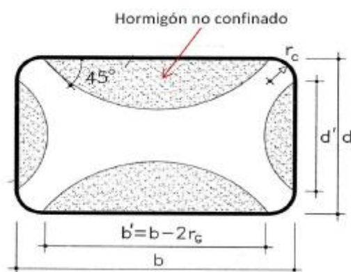
Figura 2.29. Efecto de confinamiento del núcleo de pilares no circulares.
