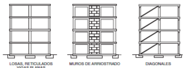
Figura 4.6. Ejemplos de organizaciones estructurales que permiten un valor del coeficiente de comportamiento por ductilidad \mu = 2 .
