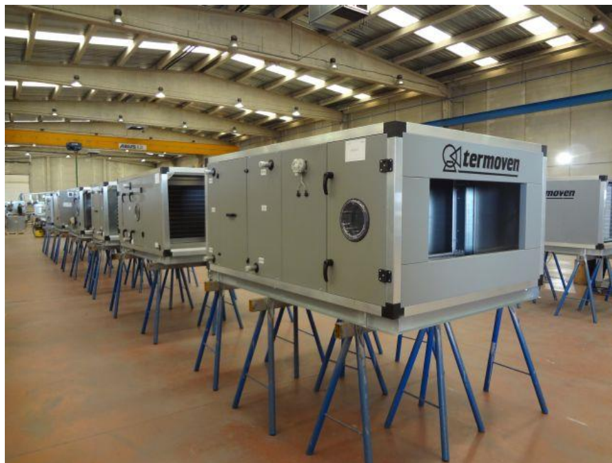
Ilustración 14: Unidad de Tratamiento de Aire (Fuente: www.termoven.es )
