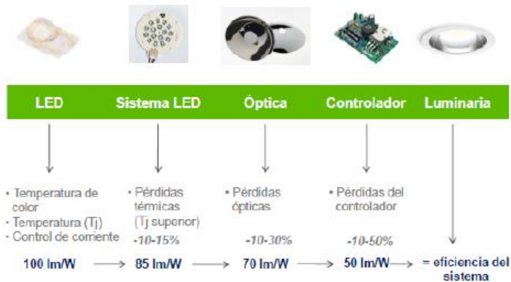
Ilustración 20: Ahorro Energético en Luminarias LED (Fuente: www.philips.com )
