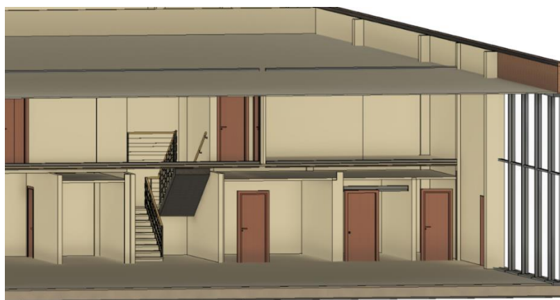
Figura 50: Falso techo zona comercial.
