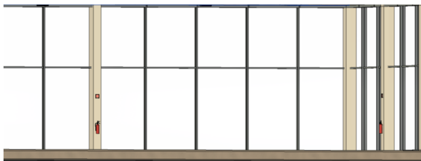
Figura 73: Extintores portátiles del sector comercial.
