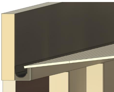
Figura 55: Canalones de recogida de aguas pluviales.
