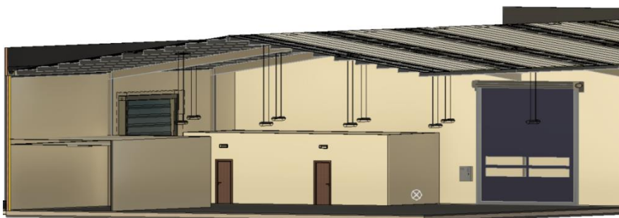
Figura 59: Ubicación luminarias zonas de actividad industrial en ausencia de falso techo.
