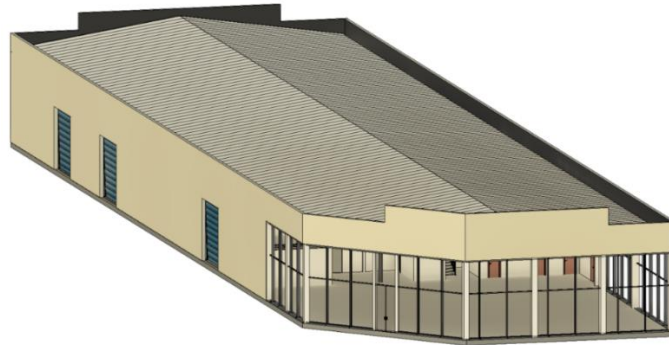
Figura 53: Vista 3D cubierta y petos.
