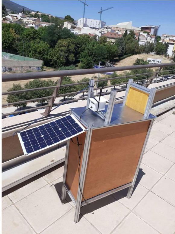
Figura 4.59. Sistema autónomo de detección de plagas
